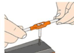
**6** - Remplacer le taraud ébaucheur par le taraud intermédiaire, et procéder de la même façon. Veiller à le visser parfaitement dans le filetage commencé par le taraud ébaucheur.
