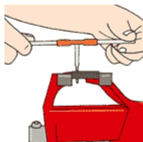
**7** - Terminer avec le taraud de finition et nettoyer le filetage au pétrole.
