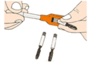
**2** - Serrer le taraud ébaucheur (le plus conique) dans le tourne-à-gauche.
