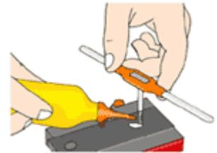
**4** - Visser le taraud sur une profondeur de 1 cm en déposant un peu d'huile de coupe. Dévisser de 3 ou 4 tours, revisser le taraud et, par étapes, tarauder jusqu'au bout.
