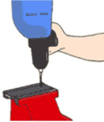
**1** - Percer le trou de taraudage avec un foret de diamètre correspondant à celui du taraudage. Déposer un peu d'huile de coupe pour faciliter le perçage.
