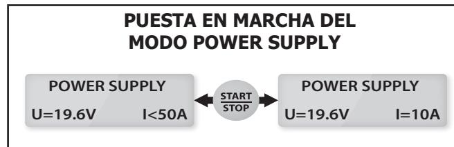
**NOTA:** A diferencia de los otros modos, en modo Power Supply el cargador no compensa la bajada de tensión en los cables. En este caso, la tensión que se indica en la pantalla corresponde a la tensión de salida del cargador (y no a la tensión en las pinzas).
