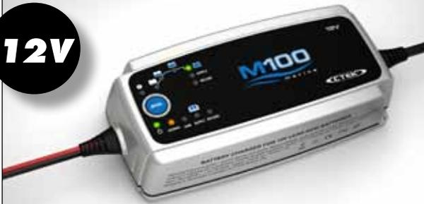
Un chargeur marin de 7 A qui offre un entretien complet des batteries des petits bateaux à batterie 12 V utilisée comme batterie de démarrage et de service. Le M100 est un chargeur entièrement automatique à 8 étapes qui fournit 7 A, il est idéal pour les batteries de 14 à 150 Ah et jusqu'à 225 Ah pour la charge d'entretien. Le mode AGM fournit une charge optimale des batteries AGM qui requièrent une tension de charge légèrement plus élevée.
