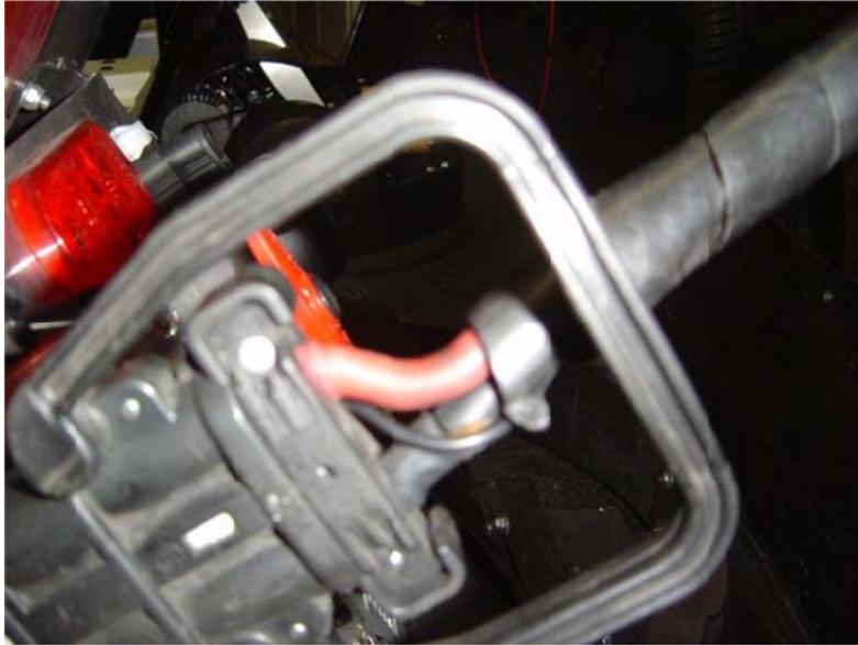
Lorsque la prise mâle du chargeur est branché sur le coté GAUCHE du kart (vue arrière dans le sens de marche), la borne positive +48V se retrouve en HAUT, ainsi que le contact auxiliaire. La borne négative –0V se retrouve en BAS. La poignée se retrouve à l'extérieur.
