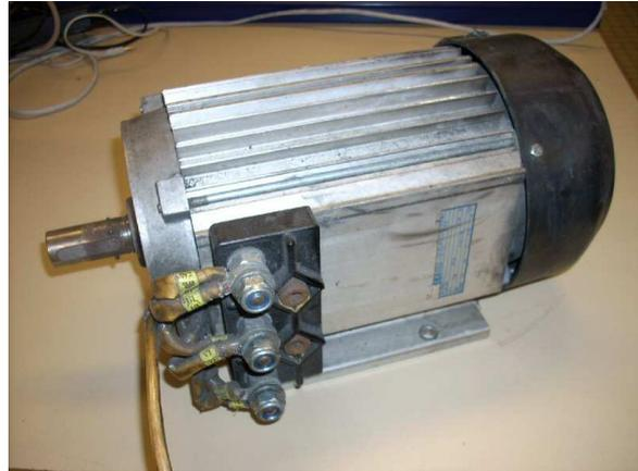
Fig. 19. Le moteur asynchrone Speed o Max.
