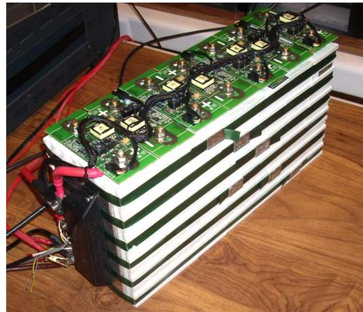
Fig. 29. Le pack batterie e-OXO LCP-100AH.
