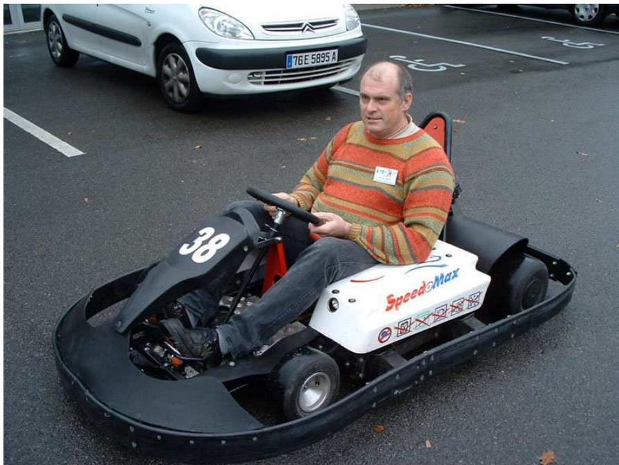
Fig. 1. Exemple du kart électrique Speed O Max (techniques/images/DSCF0393.JPG).
