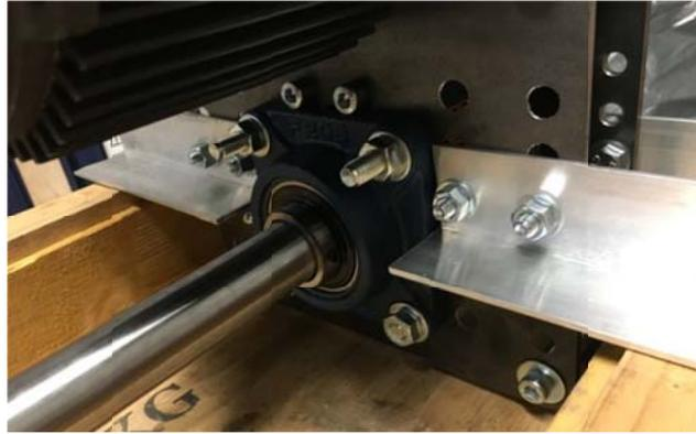
Fig. 4. Exemple de la fixation du support de transmission à une seule plaque dans le bateau.
