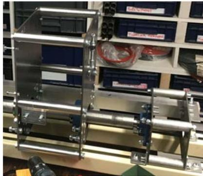
*Fig. 14. Support de transmission version D – Moteur seul et demi-plaque – Entretoise de 100 mm.*
