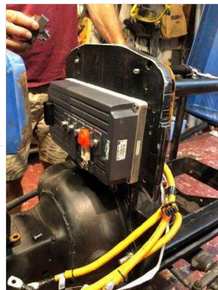
Vue du régulateur installé sur sa plaque d'adaptation
