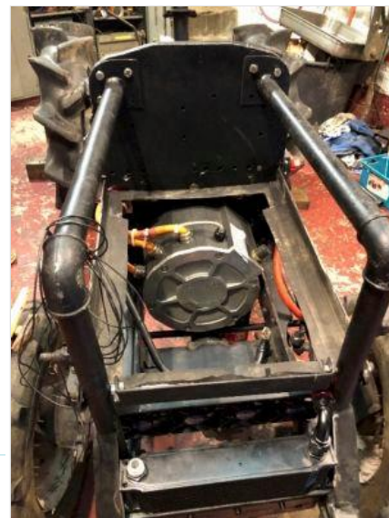
Vue du moteur électrique installé sur sa plaque d'adaptation
