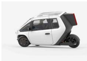
Le Vigoz vu de trois-quarts arrière. En phase d'homologation dans la catégorie automobile, il a déjà subi 300 crash-tests. Photo Cixi
