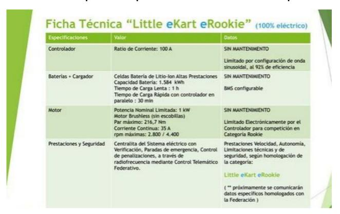
Le «Little eKart 100% électrique» est équipé de batteries lithium-ion hautes
