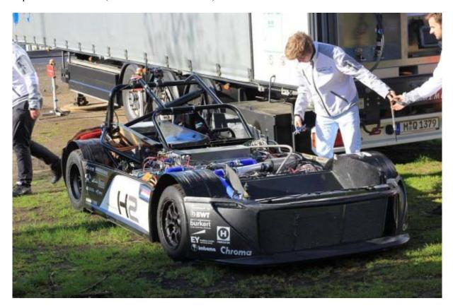
Deux réservoirs de 3 kg d'hydrogène, compressés à 350 bars, sont prévus. Théoriquement, les ingénieurs ont prévu que les 860 kg soient propulsés à 220 km/h, avec un 0 à 100 km/h en moins de 4 secondes.
