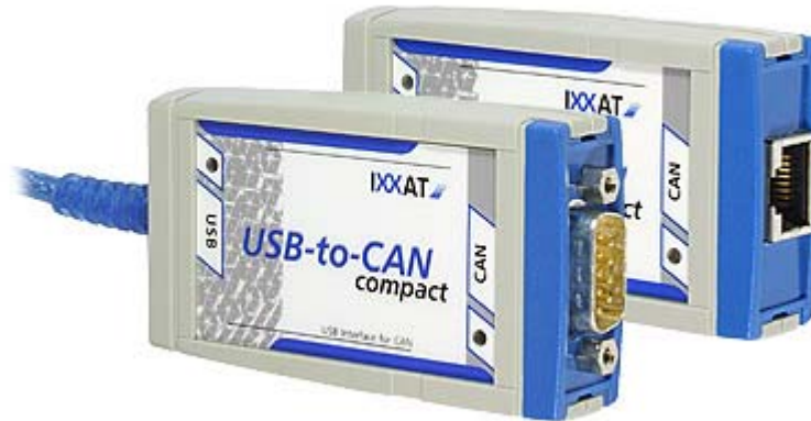
Fig. 6. Interface CAN intelligente bas coût pour port USB de chez IXXAT.
