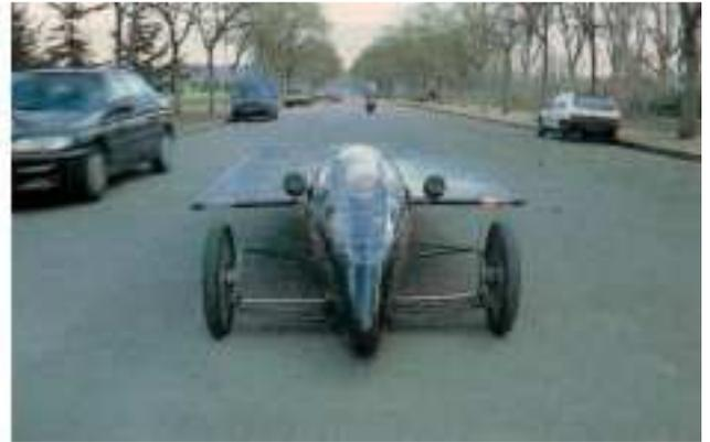
Moteur 6 kW triphasé, 5,12 m<sup>2</sup> de panneaux solaires (504 cellules) soit 500 W/h, 122 kg de batteries classiques.
